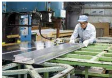
▲板が変形しないように補強し、柱と接合するための部品を溶接する様子
