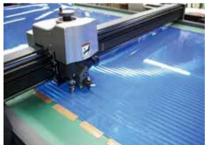
▲機械による文字の切り抜き加工
