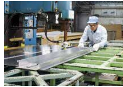
▲板が変形しないように補強し、柱と接合するための部品の溶接の様子
