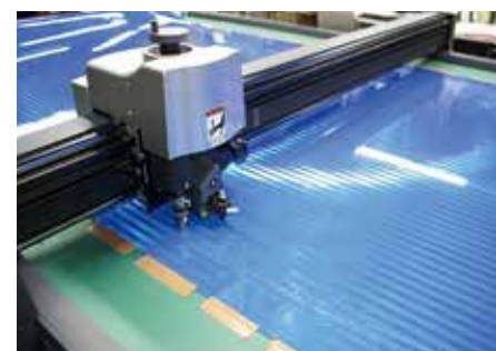
▲機械による文字の切り抜き加工
