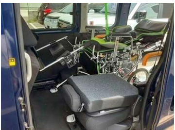
軽自動車のため小回りが利き、車いすを傾けたまま乗車できます。
