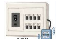
分電盤 感震センサー
