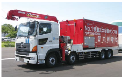
移動式大容量ポンプ車
