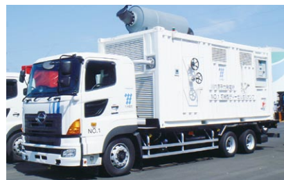
可搬型ディーゼル注入ポンプ
