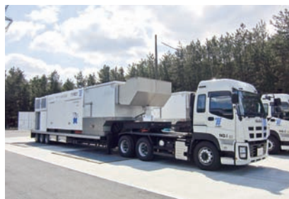
移動式大容量発電機車(4,000kVA)
