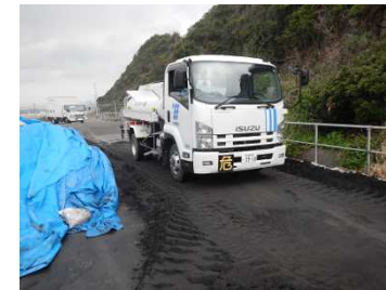
除灰後の車両走行試験
