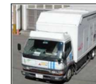
高圧発電機車
