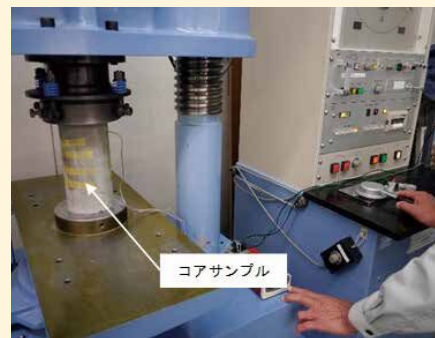
コアサンプルの圧縮強度の測定
