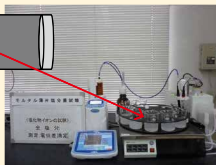
塩分の浸透を測定する機器
