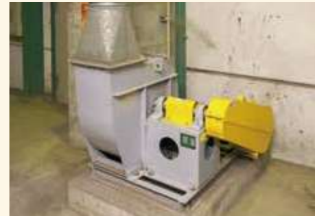
⑥ 風力選別機 回収した鉄に混ざった可燃物を風で飛ばします。
