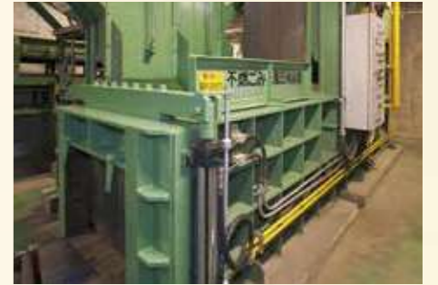
⑧ 金属圧縮機(不燃物用) 回収された鉄とアルミを別々に圧縮成型します。
