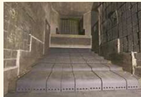
3 焼却炉 (水冷式ストーカ) 焼却炉に供給されたごみは、ストーカの摺動によって解きほぐされ、まんべんなく燃焼します。焼却炉内は約800℃~950℃の高温を維持し、ダイオキシン類の発生を抑制します。
