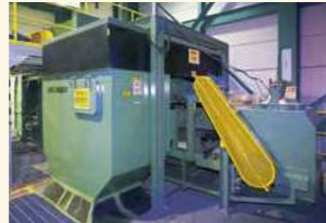
⑤ 磁選機(粗大ごみ用) 運ばれてきた破砕物から磁力を使って鉄を回収します。残りの破砕物は粒度選別機へ移送されます。
