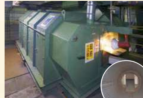
⑦ 粒度選別機 鉄を回収した後の破砕物を回転する円筒のふるいにかけて、可燃物と不燃物に分別します。
