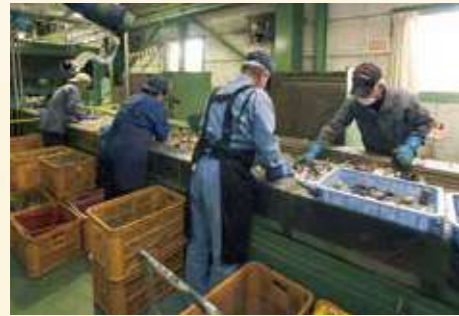
① 手選別コンベヤ 手作業により可燃物と不燃物、白色・茶色・その他の色のビン類を選別します。
