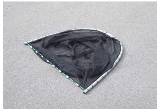
▲ 三角網 (網幅 80cm、網目 2mm)
