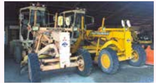
▲地面をならす重機・モーターグレーダー。雪の日には、除雪車として入来峠などで活躍し、地域に貢献します。
