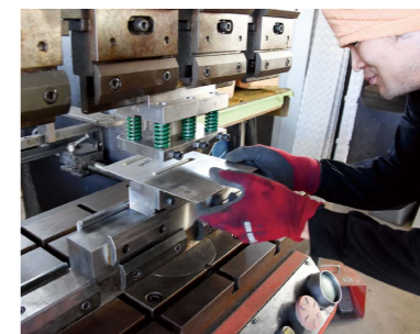
▲スマコミライト用のバッテリーボックス部品加工(圧力10トン!)
