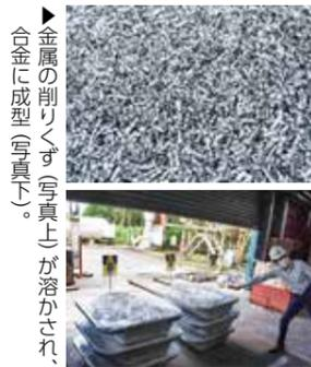
▶金属の削りくず(写真上)が溶かされ合金に成型(写真下)。
