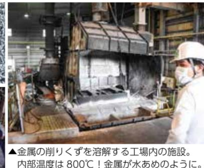
▲金属の削りくずを溶解する工場内の施設。内部温度は800℃！金属が水あめのように。
