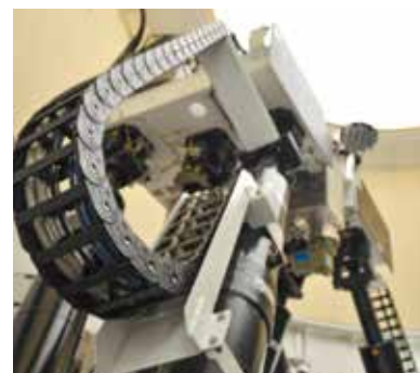
▲右と同じ部屋の装置の一部。VERAの観測の方向に合わせて、この部屋ごとぐるぐる稼働するので、コンピュータも含めて装置は全て固定されているんだって。
