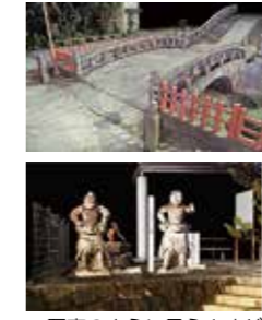
▲写真のように見えますが、レーザースキャナで計測した点群データです
