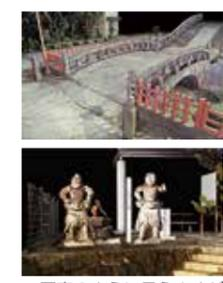
▲写真のように見えますが、レーザースキャナーで計測した点群データです
