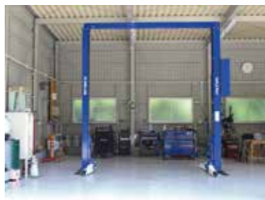
▲車両の整備作業(タイヤ交換)のため、車両を持ち上げる装置
