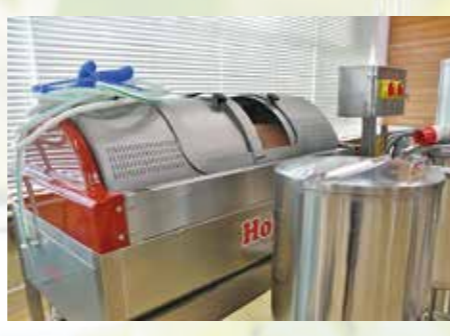
発酵後、房に含まれるアルコールを含む果汁を搾る。
