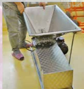
収穫したブドウを房と軸に分ける。
