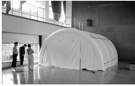
放射線防護機能を付加した屋内退避施設 (旧滄浪小体育館)
